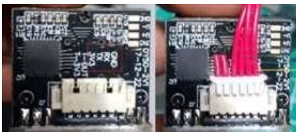
Gambar 6. Konfigurasi Modul Finger Print Tipe FPM10A [9]
